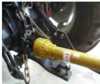
شکل 1: رابط محور PTO (الف) دینامومتر ، (ب) تراکتور
