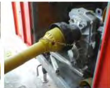
شکل 1: رابط محور PTO (الف) دینامومتر ، (ب) تراکتور
